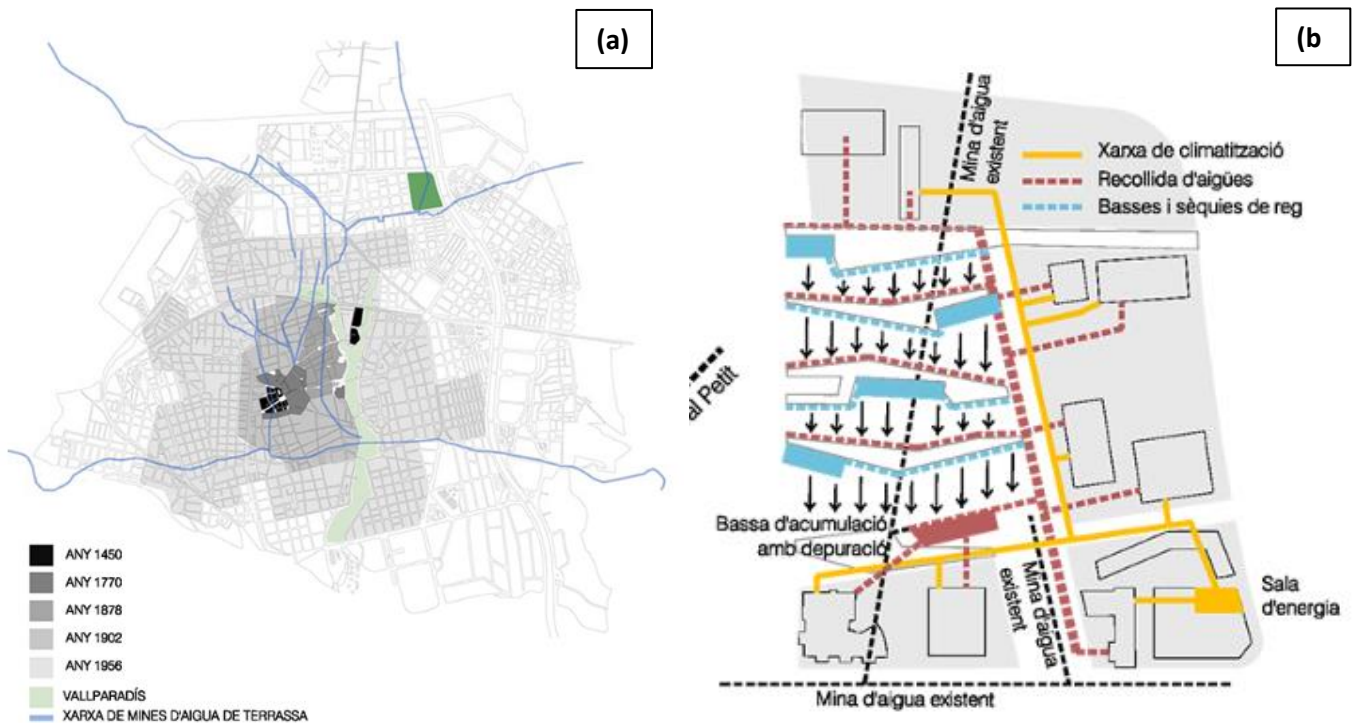
Figura 9: Localización del parque de la República dentro la ciudad de Terrassa (a) y el sistema de drenaje, riego y climatización proyectado para el parque (b). Fuente: Ayuntamiento de Terrassa.
