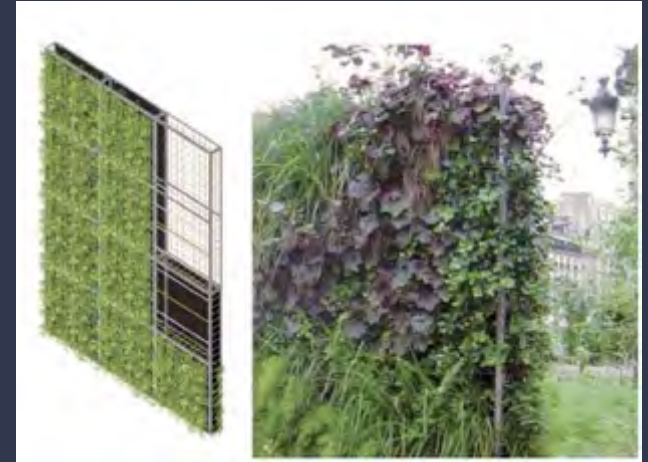
Construcción de una pared autónoma (Chalmers)
